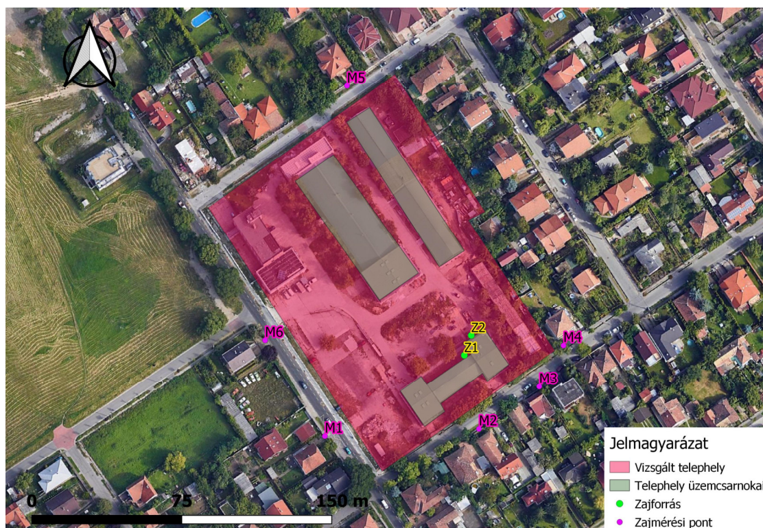
3. ábra: Mérési pontok és zajforrás elhelyezkedése
